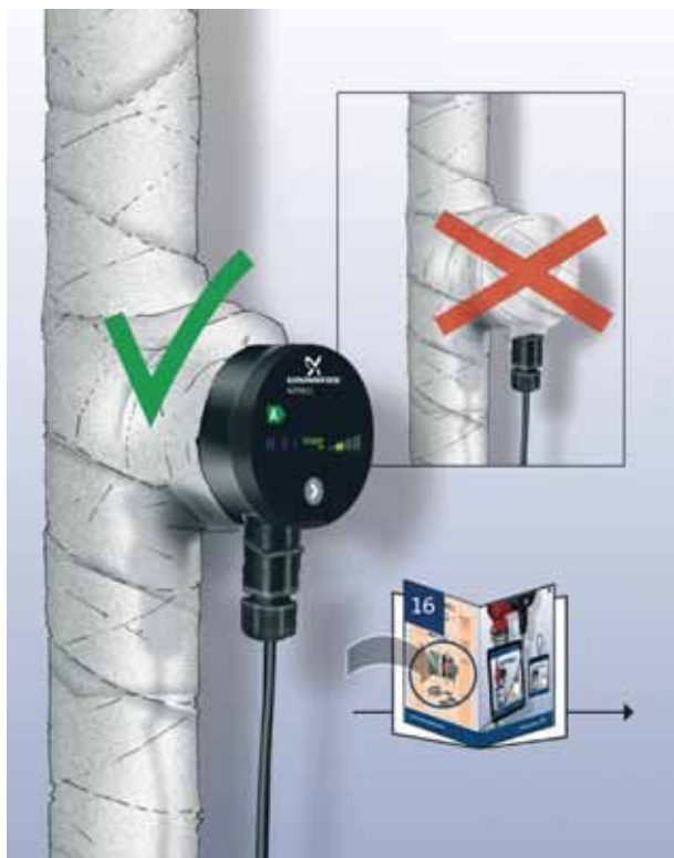
Рис. 5 Изоляция корпуса насоса
