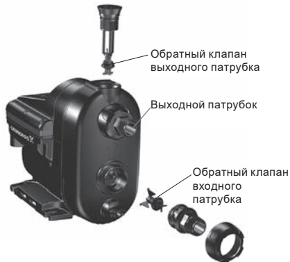
Рис. 23 Обратные клапаны входного и выходного патрубков
